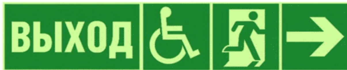
Рисунок 5 - Пример комбинации эвакуационных знаков
