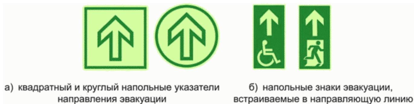
Рисунок 6 - Напольные указательные и комбинированные знаки эвакуации
