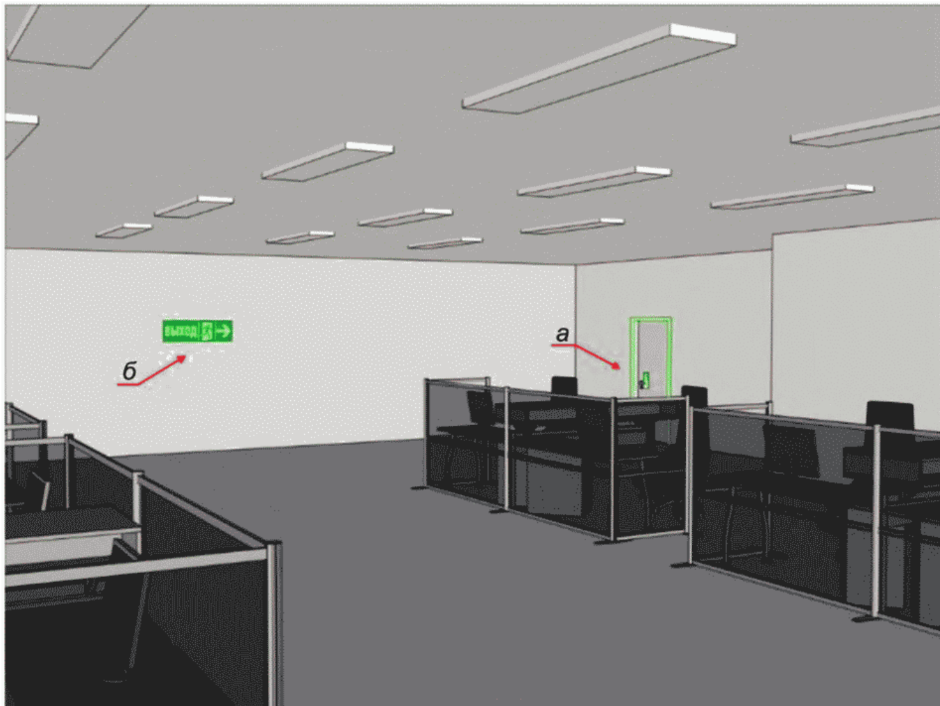
а - обозначение контура и механизма двери; б - указатель направления эвакуации Рисунок В.2 - Пример ФЭС в помещениях общего назначения, не имеющих сложной архитектуры, постоянных или временных перегородок высотой более 1,5 м (за исключением колонн)
